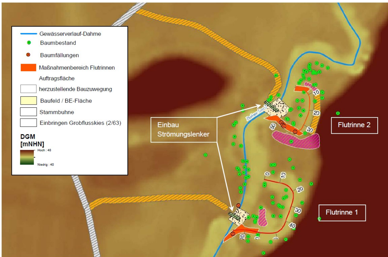
Abb. 12: Anbindung von zwei Flutrinnen Los 2 bei Briesen, Entwurfs- und Genehmigungsplanung, NSF 2018
