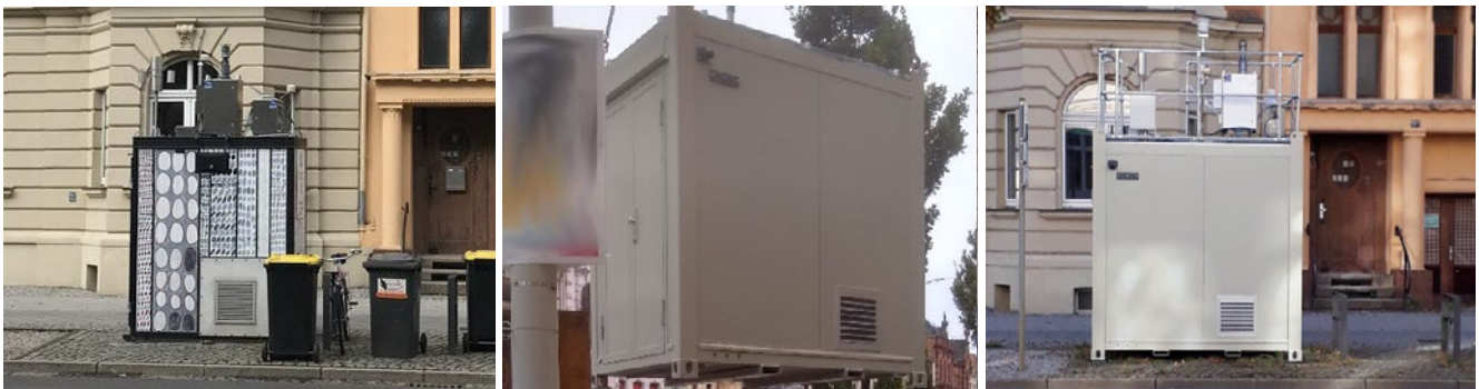
Abbildung 15: Alter Messcontainer (links), Aufstellen des neuen Messcontainers (Mitte), neuer Messcontainer mit Absturzsicherung auf dem Dach in der Bahnhofstraße in Cottbus (rechts)
