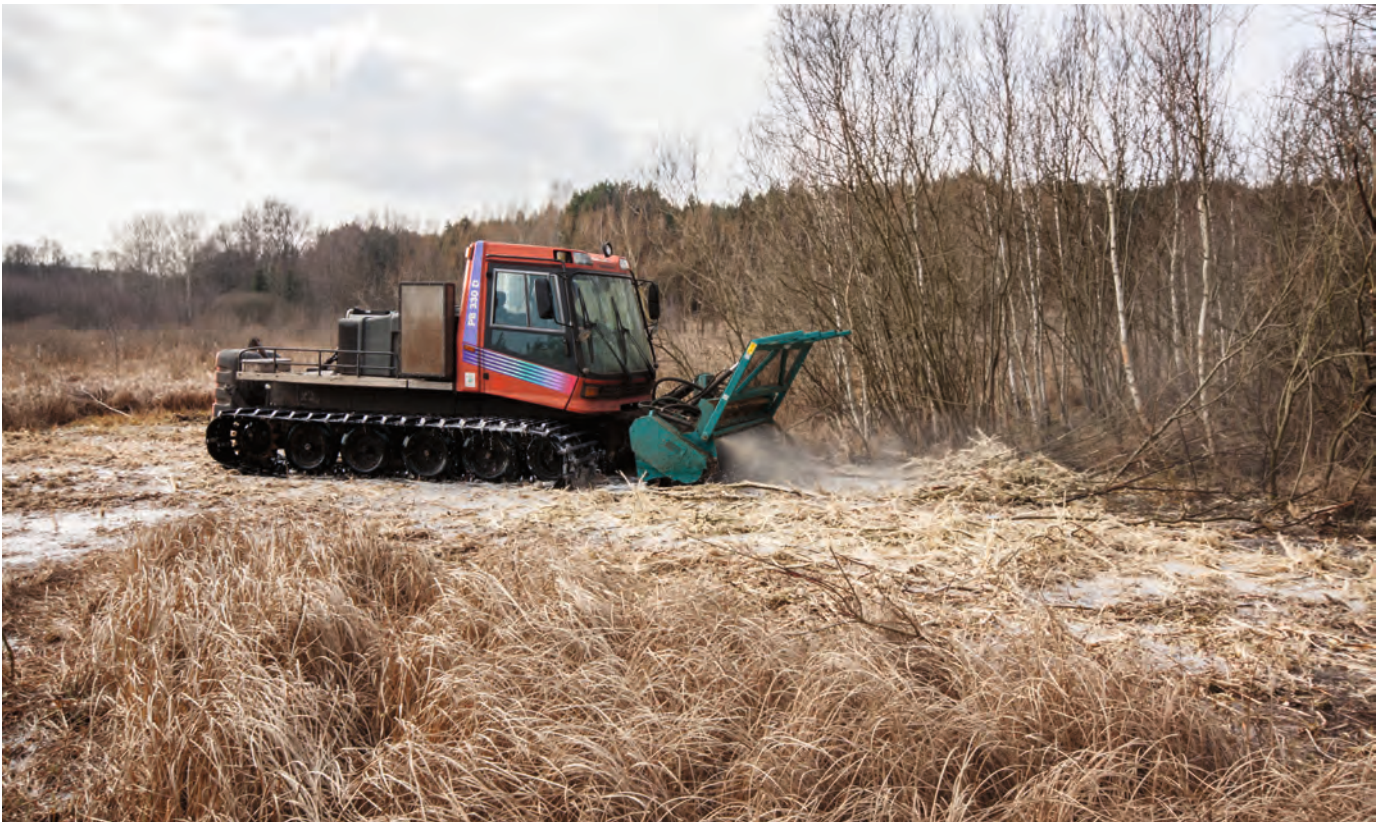
Abb. 1-11 Gehölzentnahme mit einer umgebauten Pistenraupe (Töpchiner Seen, Dahme-Spreewald, 22.02.2012)
