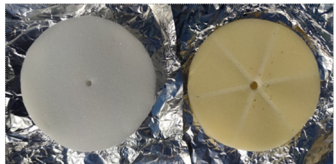
Abbildung 5: Die PUF-Filtermedien vor (links) und nach (rechts) dem monatlichen Wechsel. Quelle: LfU T14, 2022 (Geraldine Knopf)
