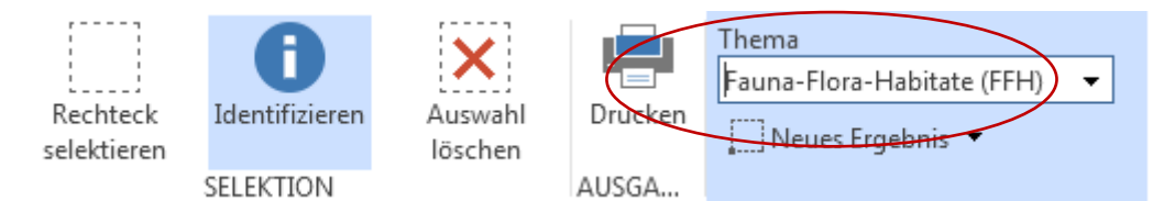
Abb. 8 - Um die Sachdaten einer Geometrie anzeigen zu können, muss zuvor das entsprechende Thema im DropDown-Menü rechts neben der Werkzeugliste ausgewählt werden.
