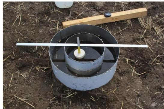
Abbildung 1: Versuchsaufbau Doppelring-Infiltrometer bei Kiez an der Elbe/Lenzer Wische (Foto: H. Fell)
