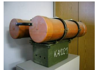
Abb. 4.3: Sedimentationskästen (Beispiele) in den Bundesländern Schleswig-Holstein, Bayern, Umweltprobenbank (UBA), Sachsen (von links nach rechts:)
