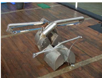
Abb. 4.4: Backengreifer (van Veen Greifer)
