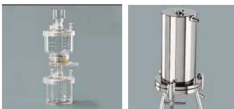
Abb. 4.5: Druckfiltration (z.B. Celluloseacetatfilter, < 0,45 \mu\text{m} )
