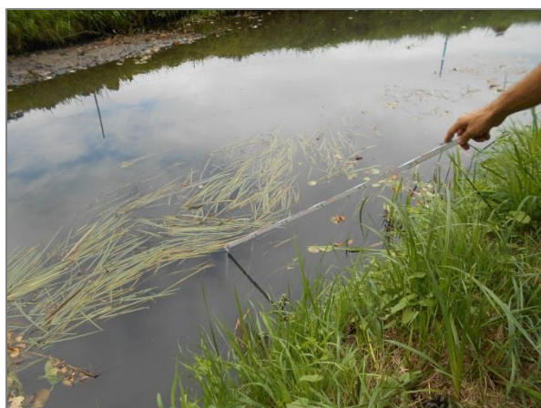
Abbildung 3.15: max. Wassertiefe= 0,40 m im Wanderkorridor (Prallhang) der Stadtnuthe, Schlammauflage teilweise bis 0,80 m
