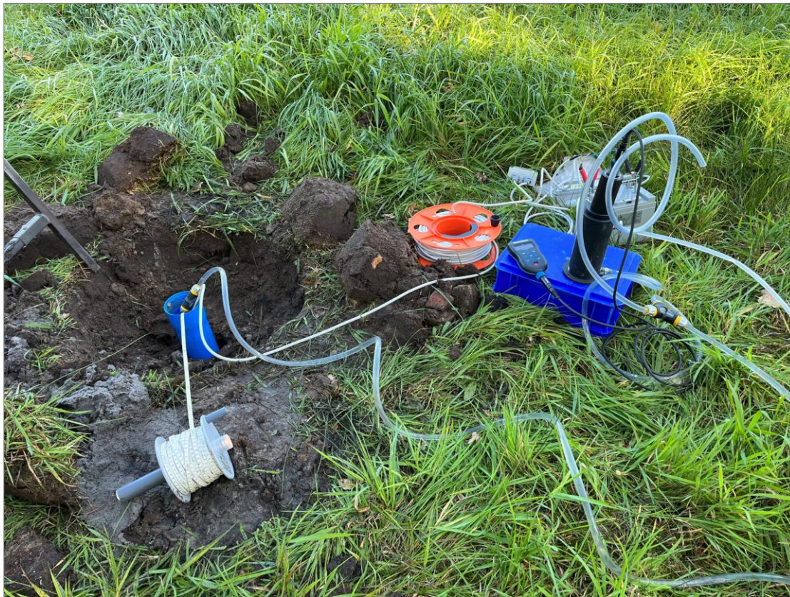
Foto 3: eingebaute Pumpe mit angeschlossenem Messequipment
