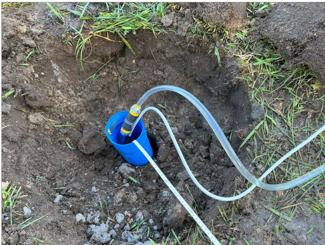
Foto 4: eingebaute Pumpe mit Lichtlot
