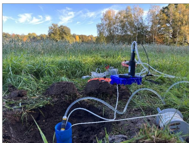
Abbildung 7.1: temporärer Pegel und Probenaufnahme Equipment
