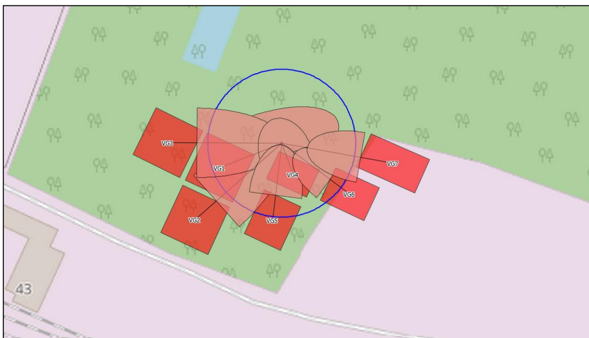
Abbildung 3-1: Schornsteinhöhe nach WinSTACC (2D)
