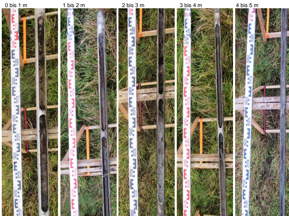
03 Kleinrammbohrung BS 11/21, Rammsondierung DPH 11/21
