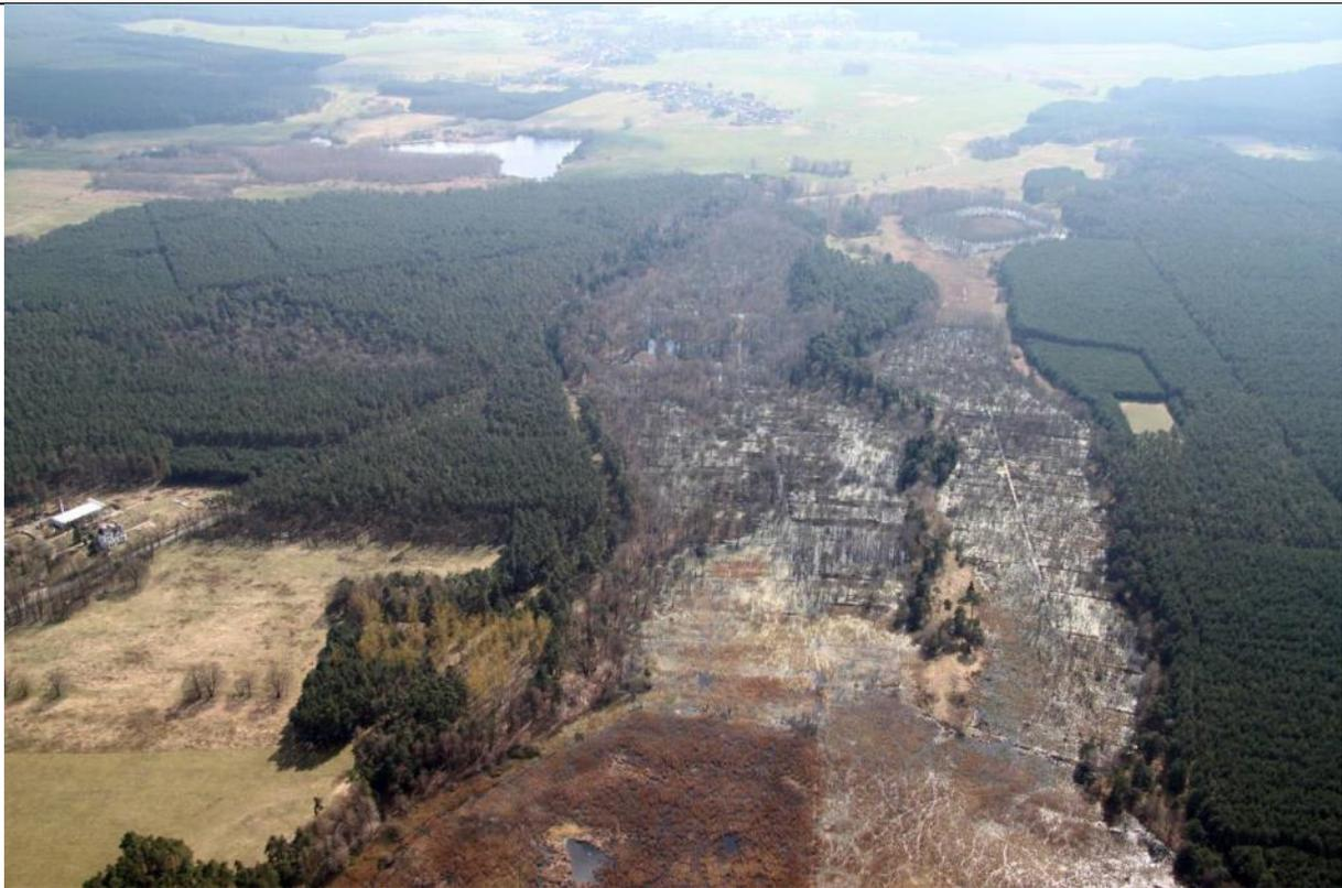
**Foto 3, 4:** Noch heute gut erkennbar ist das feinmaschige, fischgrätartig angelegte Grabensystem, was aktuell jedoch nicht mehr aktiv unterhalten wird und kaum noch entwässernd wirksam ist (Foto: F. Meyer, April 2012).
