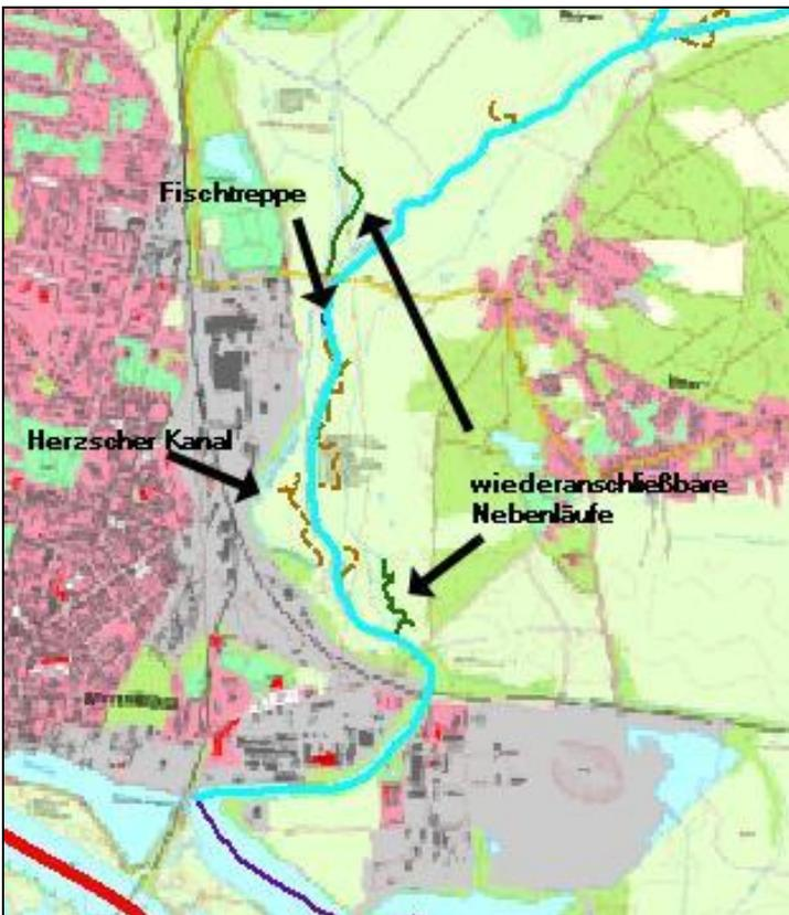
Abb. 10: Aktueller Stepenitzunterlauf mit wiederanschließbaren, wasserführenden Nebenläufen/Altläufen (grün) und verlandeten Altläufen (rot gestrichelt)
