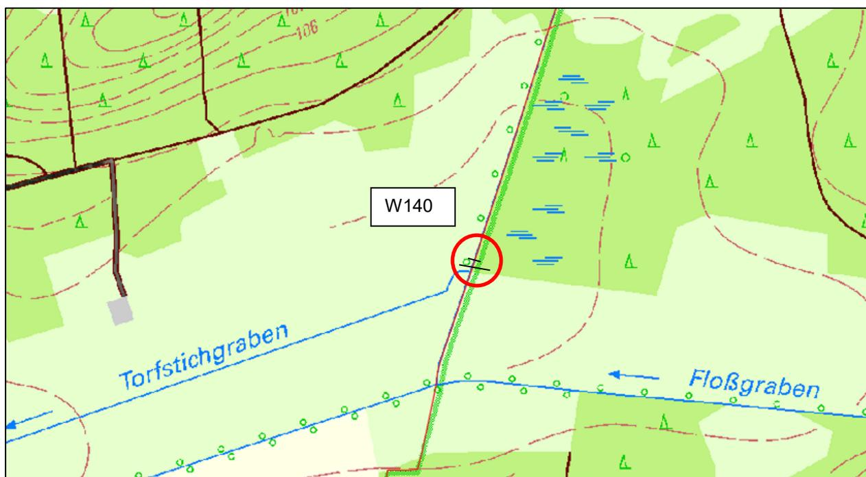
Abb. 2 Vorschlag Position einer Sohlschwelle zur Sicherung des Wassers
