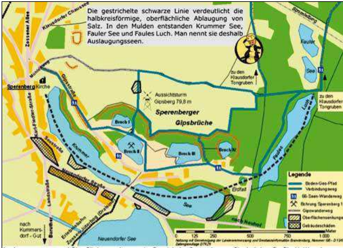
Abb. 10: Auflaugungsseen und Oberflächensenkungen (Quelle: www.boden-geo-pfad.de, 05.10.2012)
