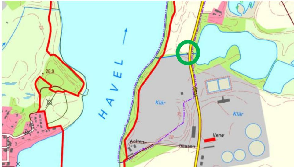
**Abb. 39: Fehlender Durchlass/Berme im Zuge der L 911 über den Katharinengraben**
