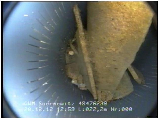
Abbildung 5: Auflandung durch Fremdkörper
