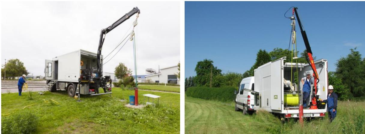
Abb. 1: Mobiles Tiefpumpfahrzeug MTP-350 (links) und mobiler Tiefpumpanhänger MTA-200 (rechts) bei der Probenahme an tiefen Grundwassermessstellen am Standort Königstein
