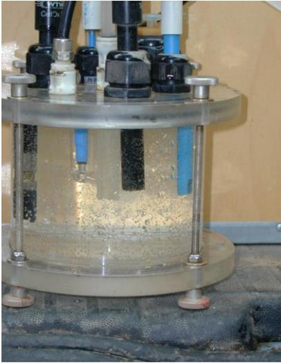
**Abbildung 5: Aufnahme einer Durchflussmesszelle mit sichtbarer Gasblasenanhaftung an den Elektroden**
