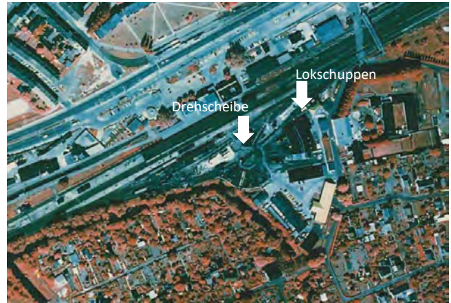
Abbildung 19: Luftbildauswertung – geometrische Information: relative Lage von Objekten; Quelle: PRO UMWELT & Partner GbR (2004) Historische Erkundung „Altes Gaswerk“ Brandenburg an der Havel; Ursprungsquelle Untere Wasserbehörde, Bernd Gabrysiak
