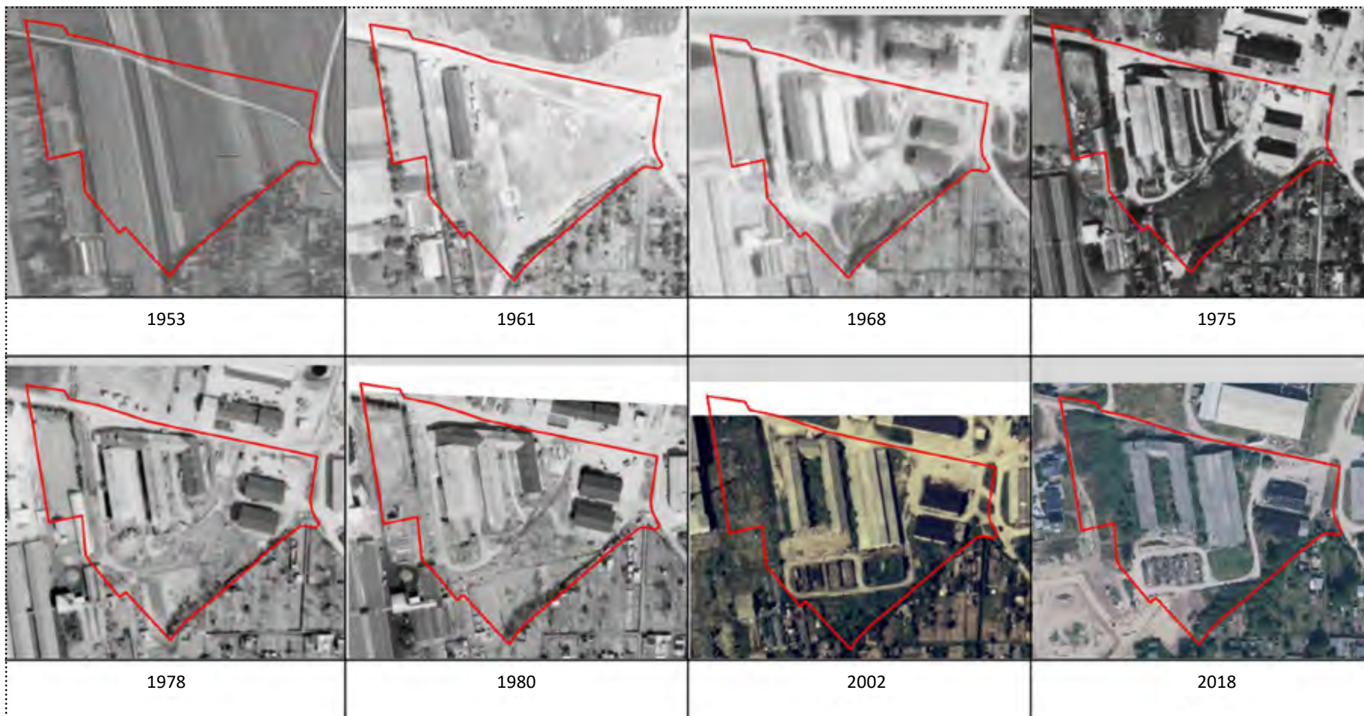
Abbildung 17: Luftbildbeschaffung – Beispiel einer baulich bewegten, altlastrelevanten Flächenentwicklung von 1953 – 2018; Quelle: PRO UMWELT C. Jaggi e. K. (2019) Historische Erkundung, B-Plangebiet Nr.34-2, Grevesmühlen im Auftrag der Grevesmühlener Kommunale Bau GmbH; Ursprungsquellen www.https://www.geoportal-mv.de/portal/Geodatenviewer/GAIA-Mvprofessional und Bundesarchiv Berlin [21], (bearbeitet durchs LfU)
