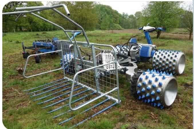
Produkte & Dienstleistungen Unter anderem: Schlitz-Nachsaatgerät in leichter Ausführung zum Anbau an Brielmaier-Motormäher und/oder Kompaktschlepper. Das Gesamtgewicht ist minimiert und eine Überfahrt ohne zusätzliche Bodenverdichtung möglich.
