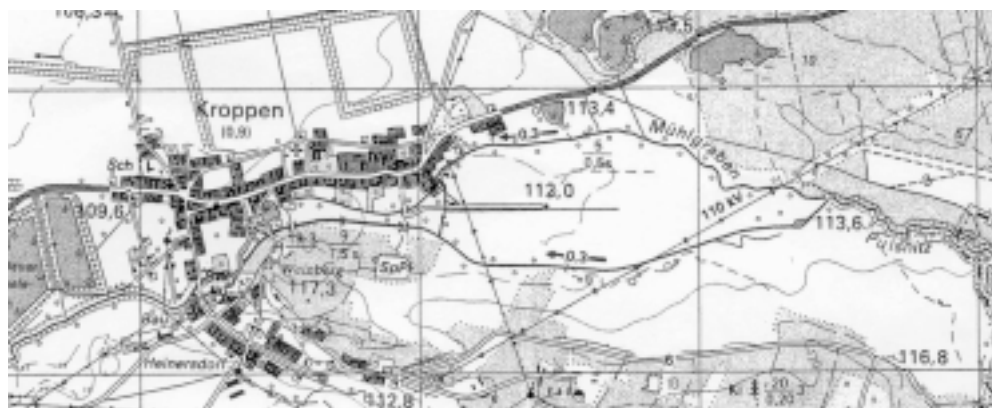
Abb. 4: Oben: Ursprünglicher Verlauf (Krümmungstyp) der Pulsnitz und der Schwelle bei Kroppen im südlichsten Brandenburg in der geologischen Karte von ca. 1920. Damals war die Schwelle das gewundene und mäandrierende Hauptgewässer, während die Pulsnitz als künstlicher, gestreckter Graben verlief. Unten: Heute heißt die Schwelle Pulsnitz und wurde stark begradigt, so dass ihre Linienführung gestreckt ist. Der ehemalige Grabenabschnitt der Pulsnitz heißt nun Mühlgraben.
