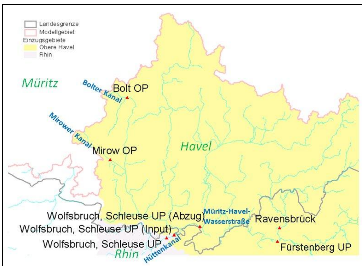
Abbildung 3-5: Überleitung aus dem Havel- ins Rhin-Einzugsgebiet
