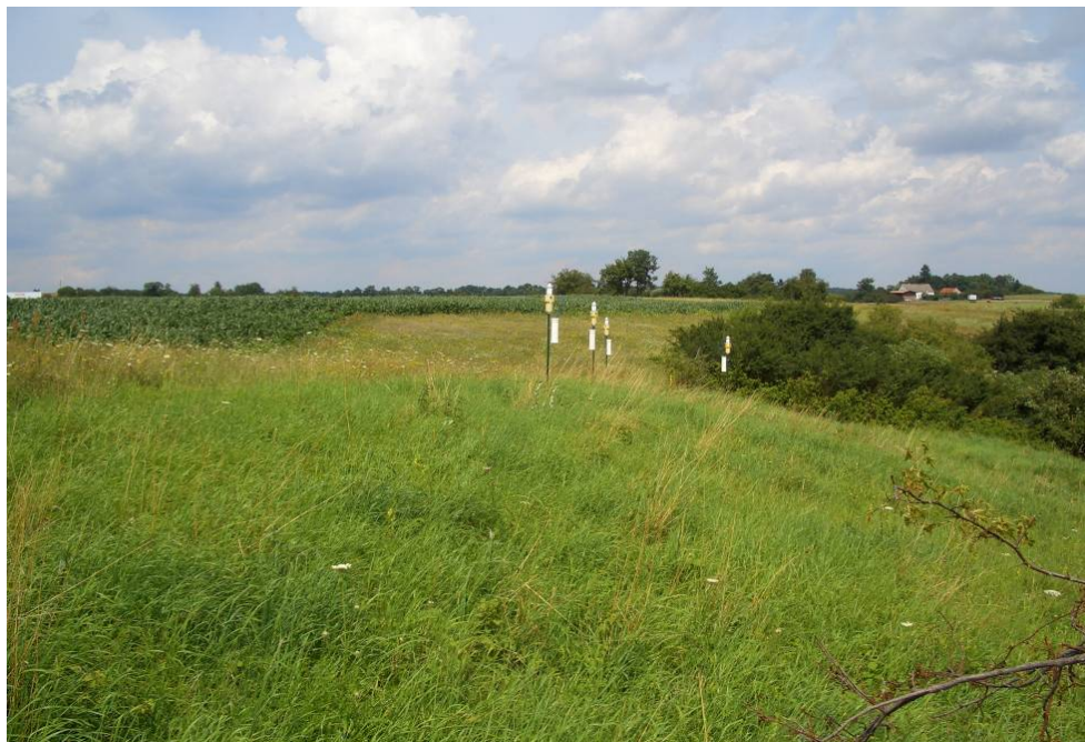
Abb. 7: Technische Pollensammler Sigma-2/PMF im NSG Ruhlsdorfer Bruch (Standortbereich II, Sammler Nr. 7 – 10)
