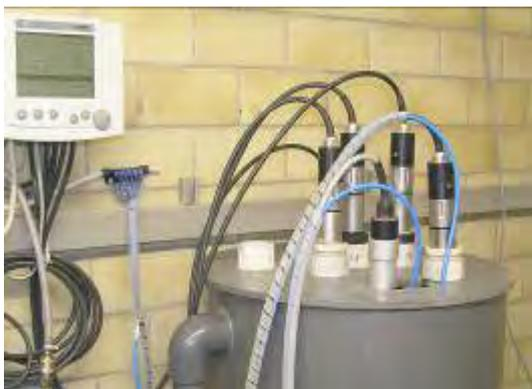
**Abb. 3.2.1.-6: Sensoren im Probenwasserstrom**
