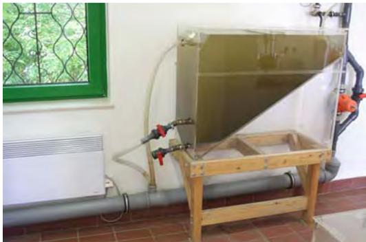
**Abb. 3.2.1.-5: Sedimentationsbecken, Messstation Frankfurt (Oder)**
