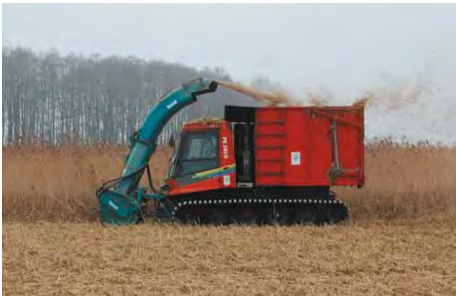
Abb. 8: Große Landröhrichtflächen im Ochsenbruch, am Südostufer des Potzlowsees, werden durch Mahd mit der Moorraupe wieder nutzbar gemacht Foto: M. Zauft
