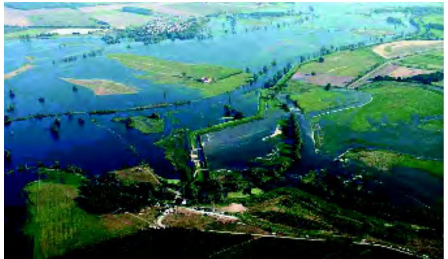
Abb. 2 Polder Warnau während der Flutung am 21.8.2002 Deutlich ist im Bildvordergrund die Deichöffnungsstelle zu erkennen
