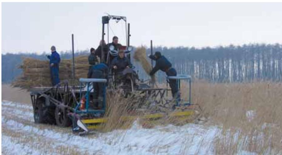
Abb. 12: Winterbeerntung von Schilf mit einer umgebauten Saiga-Maschine in Nordwestpolen
