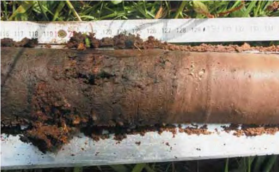
Abb. 6: Grenze zwischen Torf und Kalkmudde in 125 cm Tiefe in einem Verlandungsmoor (Bohrkern einer Moorklappsonde) Foto: N. Roßkopf
