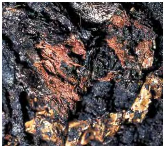
*Schneidentorf mit Schilf, hoch zersetzt, Schneidenstängel mit rotbrauner Grundmasse und glänzender Oberfläche*
