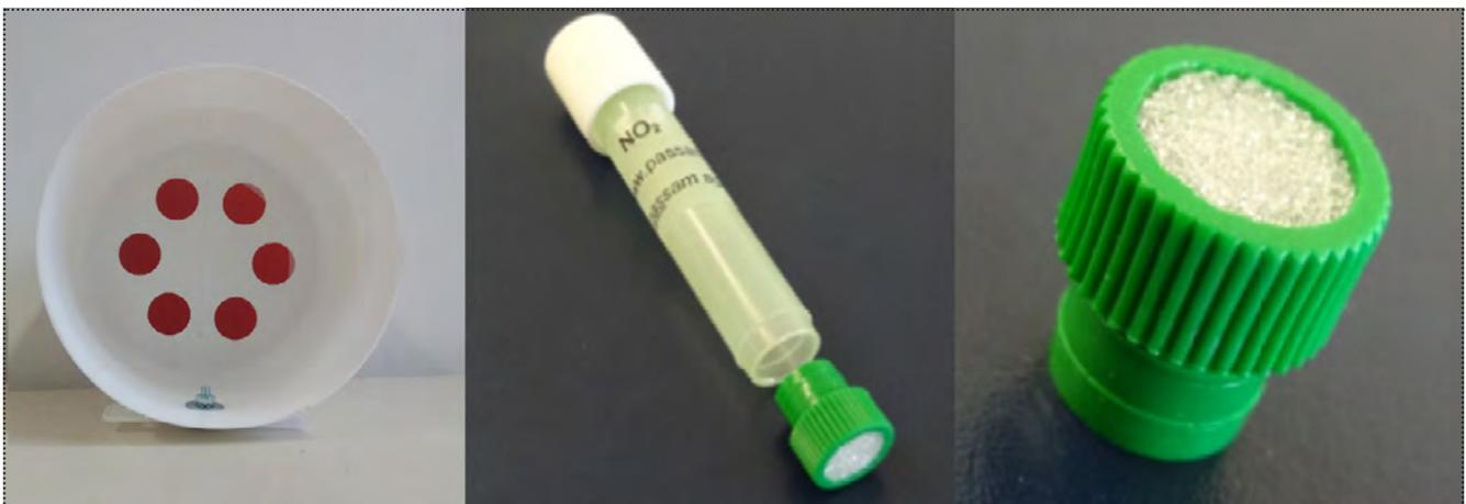
Abbildung 8: Passivsammler-Messequipment (Fa. Passam). Von links nach rechts: Aufnahme eines Proben-Schutzbehälters, eines  $\text{NO}_2$ -Passivsammlers und Nahaufnahme der zugehörigen Glasfritte.
