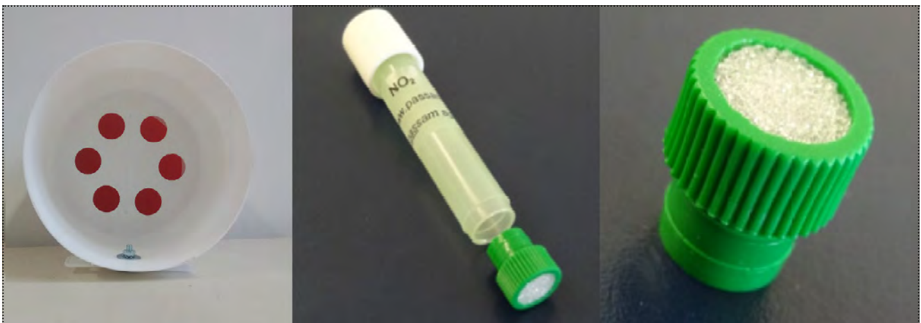
Abbildung 6: Passivsammler-Messequipment (Fa. Passam). Von links nach rechts: Aufnahme eines Wetterschutzgehäuses, eines \text{NO}_2 -Passivsammlers und Nahaufnahme der zugehörigen Glasfritte.
