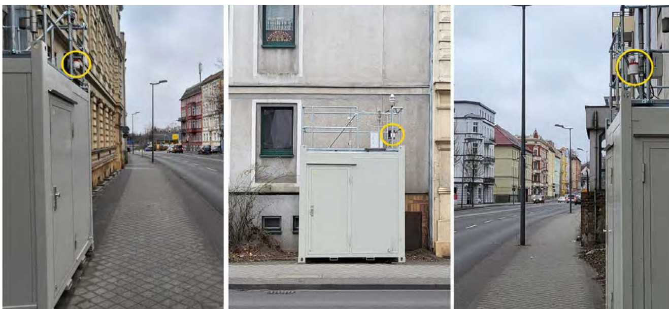
Abbildung 2: Messstellen für MP 01 und MP 02 am verkehrsbezogenen Messcontainer in der Leipziger Straße
