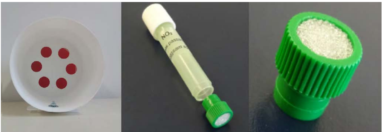
Abbildung 12: Von links nach rechts: Aufnahme eines Proben-Schutzbehälters, eines \text{NO}_2 -Passivsammlers der Firma Passam und Nahaufnahme der zugehörigen Glasfritte
