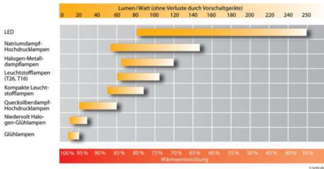
Abbildung A.9-3: Lichtausbeuten verschiedener Leuchtmittel
