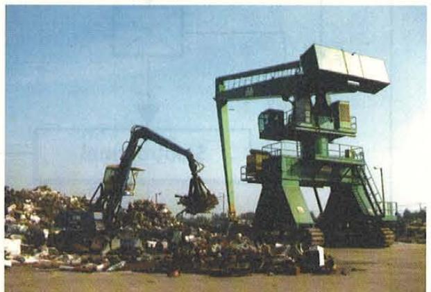
Bild 5: Balancekran und Mobilbagger mit Greifer
