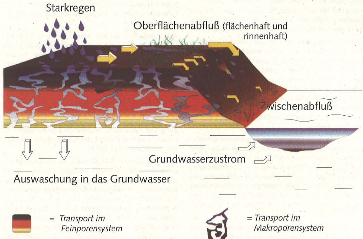
Abb. 9: Transportpfade von Niederschlagswasser im gewässernahen Boden (incl. Bypass-Effekt)
