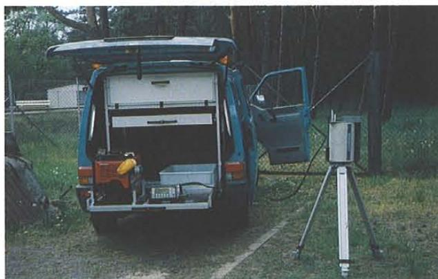
Abb. 11: Meßfahrzeug der Strahlenmeßstellen zur in-situ Gammaskpektrometrie
