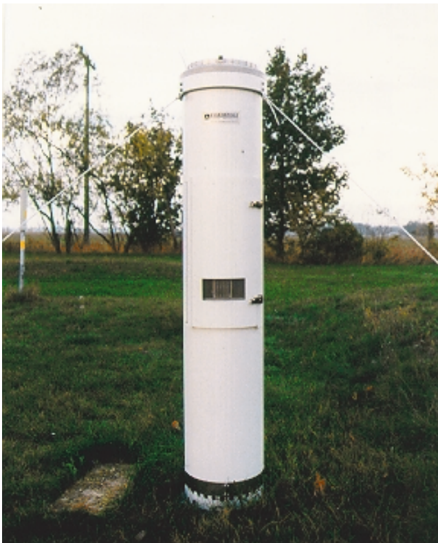
Abb. 5.2. Bulk-Sammler des LUA Brandenburg mit integrierter Kühlung
