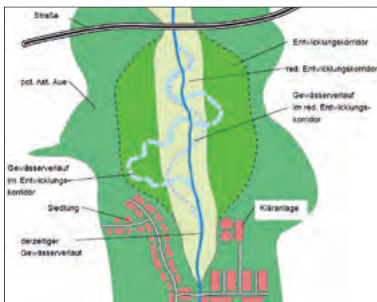
Abb. 5-2: Schematische Darstellung des Entwicklungskorridors unter Berücksichtigung lokaler Restriktionen auf der konzeptionellen Ebene (aus „Leitlinien zur Gewässerentwicklung“, LAWA 2006)
