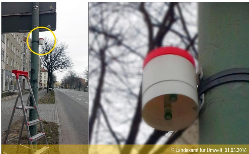
Abb. 9: Installation von Probenröhrchen im Schutzbehälter an einem Schildmast
