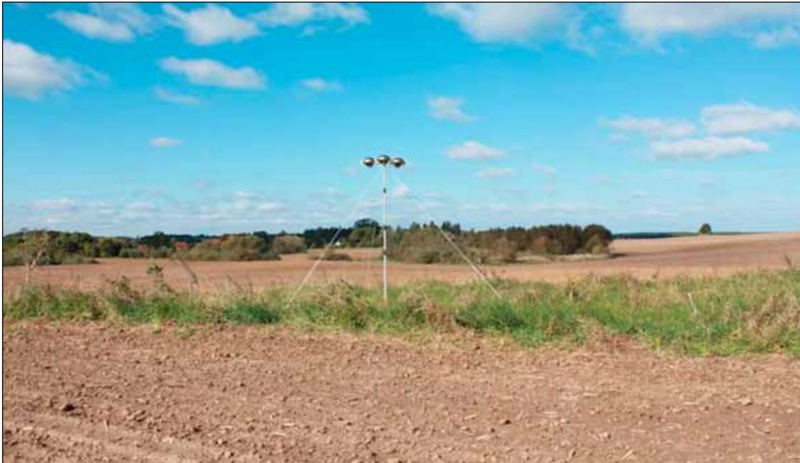
Abb. 21: Passivsammler-Einrichtung am Messpunkt P02, Referenzstandort mit Pendimethalin-Applikation auf umliegenden Wintergetreide-Feldern
