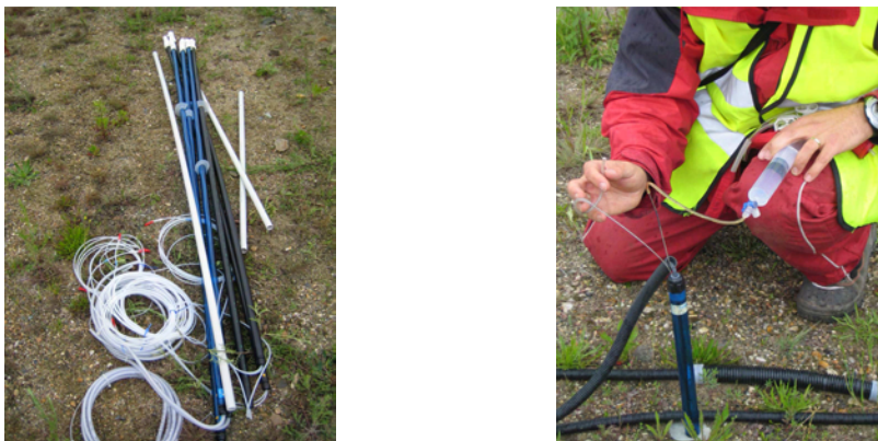
Abbildung 12: links – Saugkerzen und Tensiometer; rechts – hydraulische Anbindung der Saugkerzen
