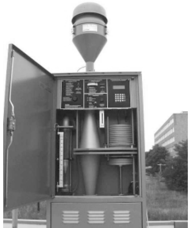
Geöffnetes automatisches Probenahmegerät für Schwebstaub
