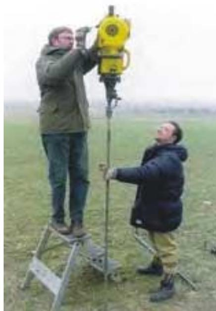
**Bild 8:** Kleinrammbohrung mit Wackerhammer und Bohrkerne (Quelle: Siebenborn, 1998)
